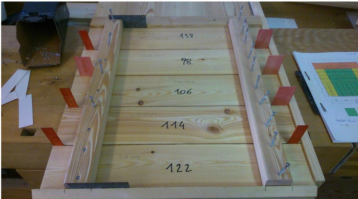
Abbildung 14: Zusammenbau der Muster zu Bewitterungsfelder
