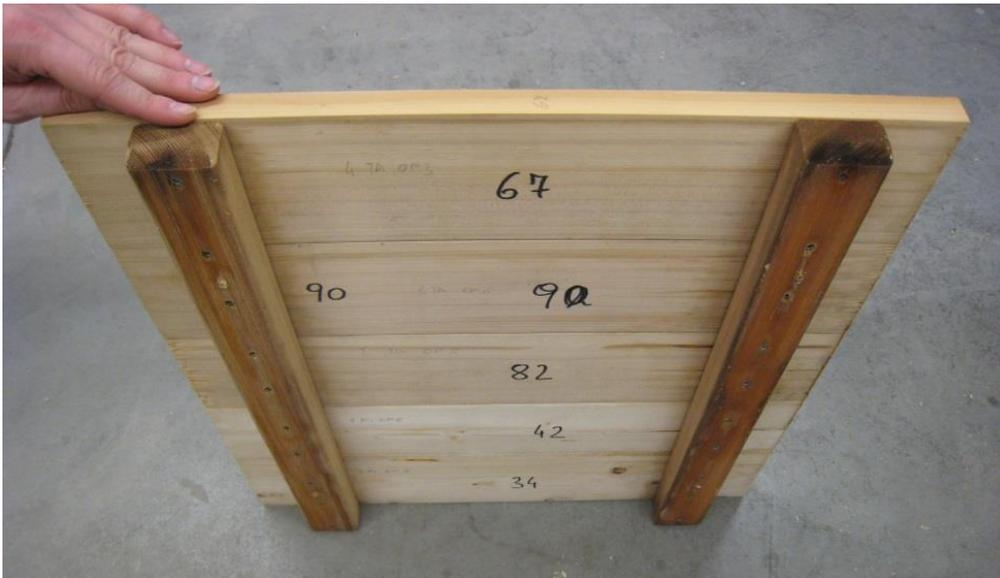
Abbildung 22: Demontiertes Bewitterungsfeld nach der Bewitterungsprüfung mit durchfeuchteter Unterkonstruktion
