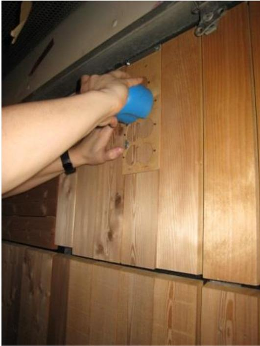
Abbildung 20: Farbmessung mit Messschablone in der Prüfkammer nach dem Bewitterungsversuch
