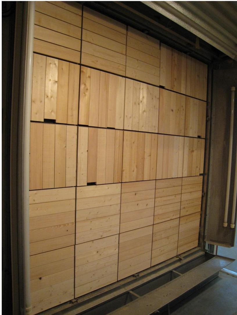
Abbildung 9: Belegung der Prüfkammer vor Bewitterungsstart
