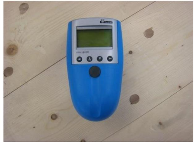
Abbildung 21: Farbmessgerät - BYK Gardner, Color-guide
