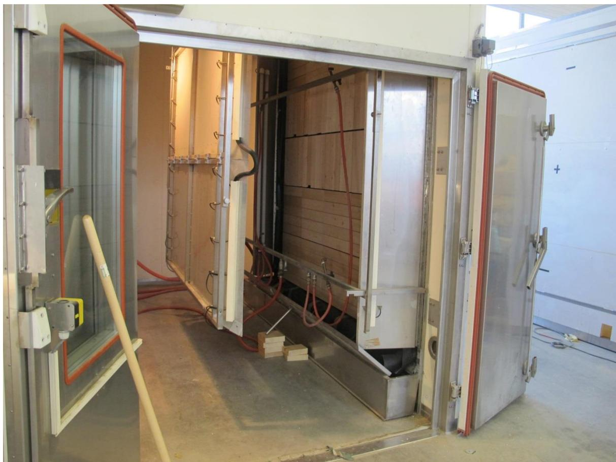
Abbildung 10: Differenzklimakammer mit geöffneten Türen. Die 25 Bewitterungsfelder sind montiert, das Beregnungsmodul vorgehängt und das UV-Bestrahlungsmodul für die Kurzbesichtigung von der Prüfwand weggeklappt.
