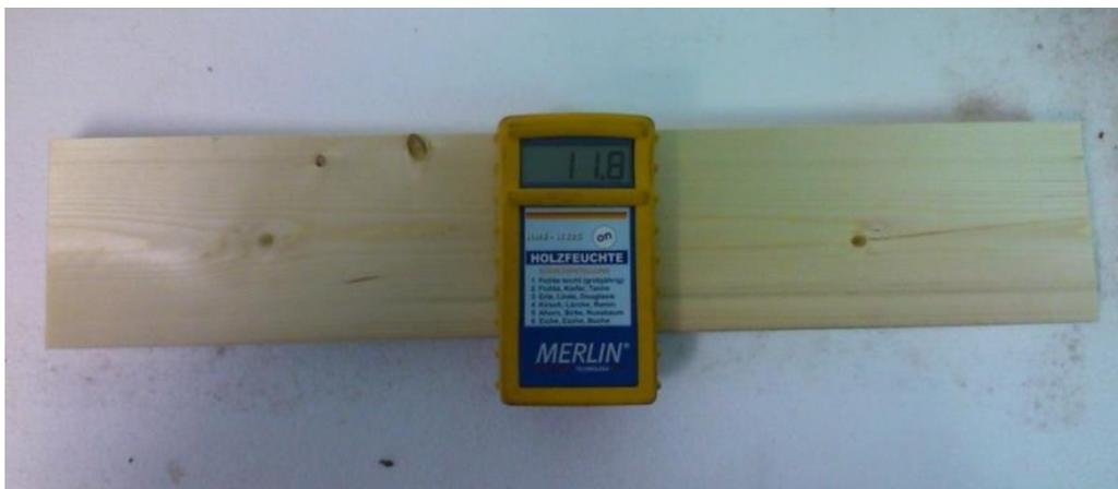
Abbildung 18: Messung der Holzfeuchtigkeit mit Merlin HM8 – WS25, darunter eine Styroporunterlage
