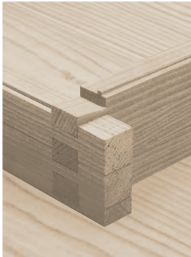
Abb.12: Konstruktionsmodell vertikale Fügung mittels „Verzinkung mit einseitigem Vorstoß“
