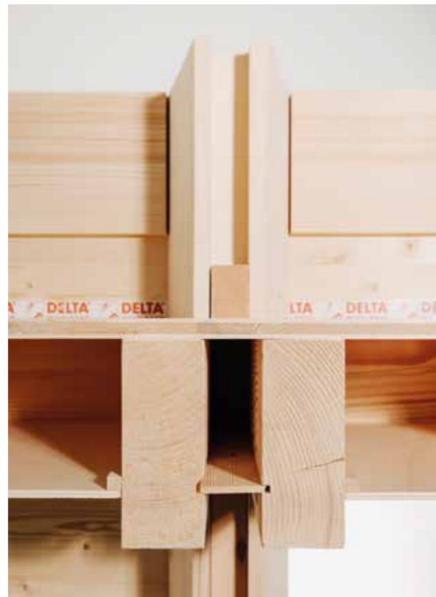
Mockup 1:2 Detail- Rippendecke
