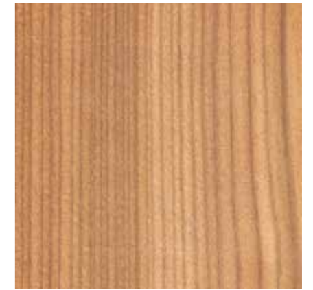
Abb. 24 Fassadenschirm heim. Lärche, unbehandelt
