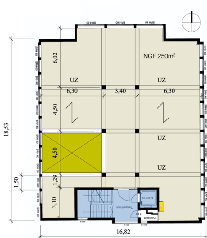
Abbildung 15 Darstellung der Tragstruktur Untersuchungsobjekt 1
