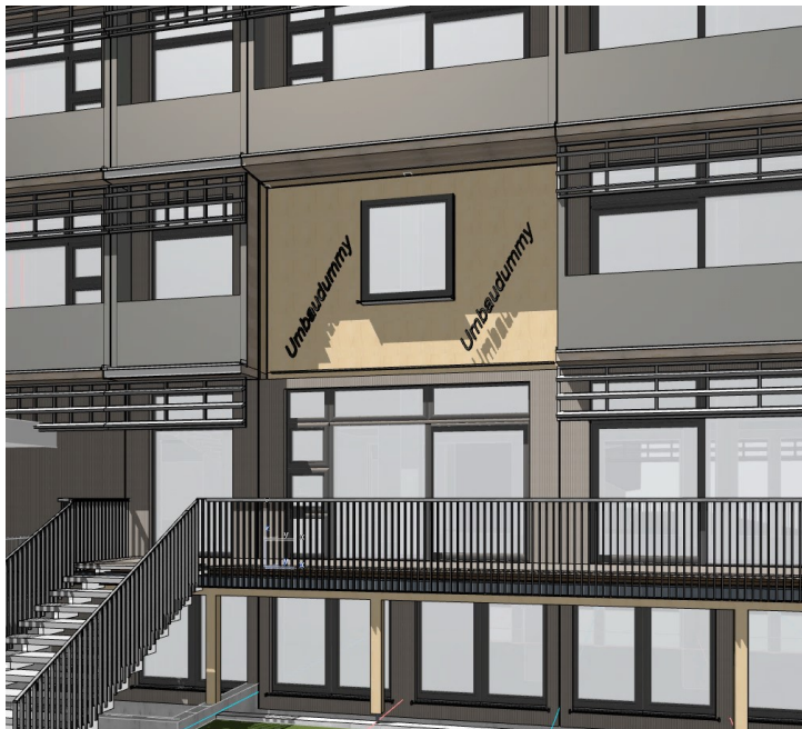
Abbildung 153 / Temporär verschlossene Fassade
