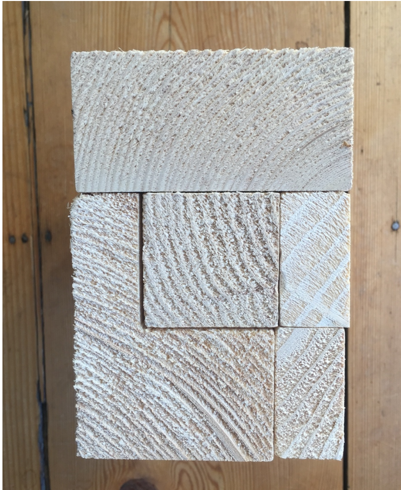
Abbildung 62 Experimentierblock aus einzelnen Hölzern zur Entwicklung von Verbindungspunkten
