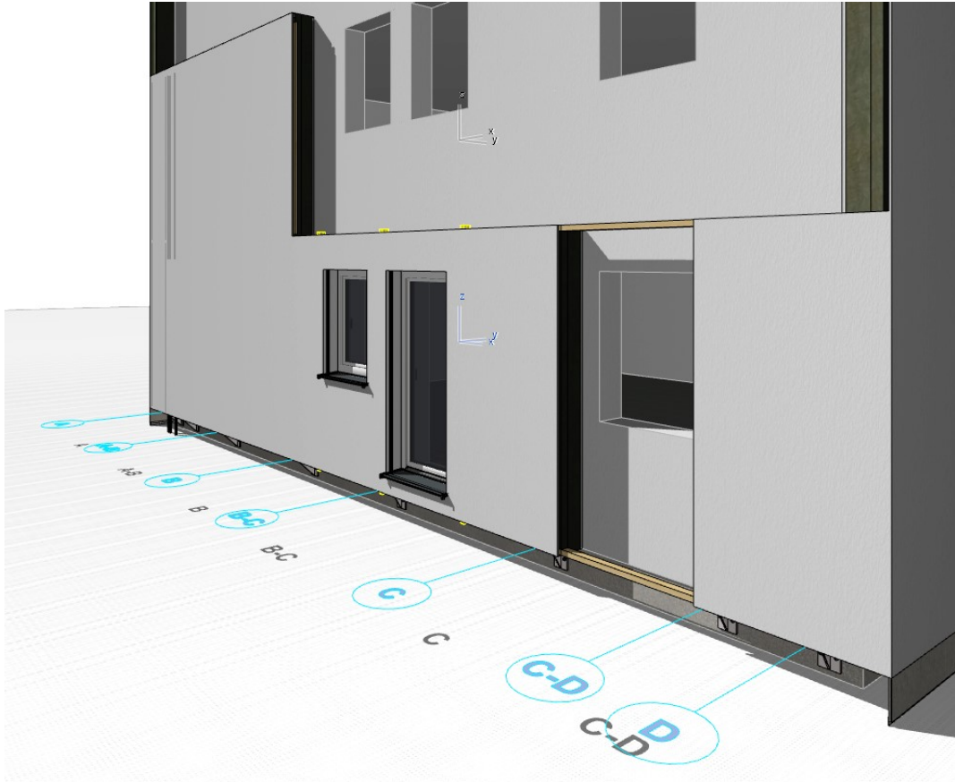
Abbildung 170 / Nach Montage Fenster- Türelemente inkl. Schichten
