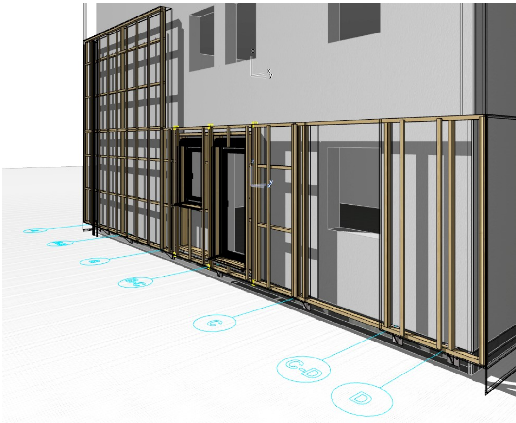
Abbildung 169 / Nach Montage Fenster- Türelemente (Schichten ausgeblendet)
