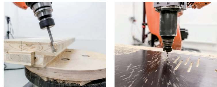
Fertigung von Bauteilen und Verbindungen aus Holz im Labor für Kreative Robotik der Kunstuniversität Linz
