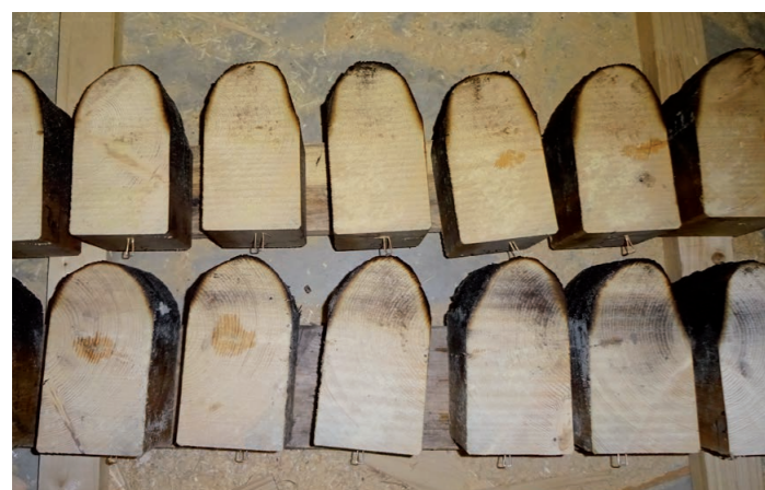
Markus Hager: Brandversuch am Kleinbrandprüfofen im IBS – Institut für Brandschutz, Linz; Verbliebene Restquerschnitte nach Entfernung der Kohleschicht
